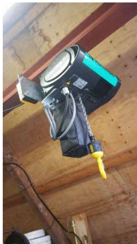
Nieuwe Verlinde elektrisch kettingtakel met hijssnelheid van 16 mtr/min.
