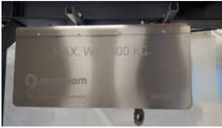
Een takel voorzien van volledige RVS omkapping en speciaal behandeld voor gebruik binnen de farmaceutische omgeving.
