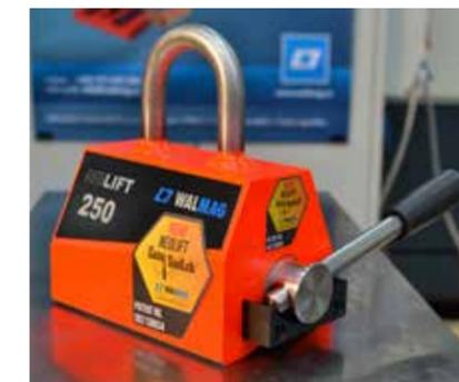
Les aimants de levage Neolift ont été conçus pour un usage intensif. Ils sont par défaut adaptés au levage de matériaux plats et ronds. L'utilisation d'aimants Neodymium permet d'atteindre des capacités de levage élevées. Tous les aimants sont soumis à des tests individuels en usine et possèdent un coefficient de sécurité qui est au moins égal à 3.
