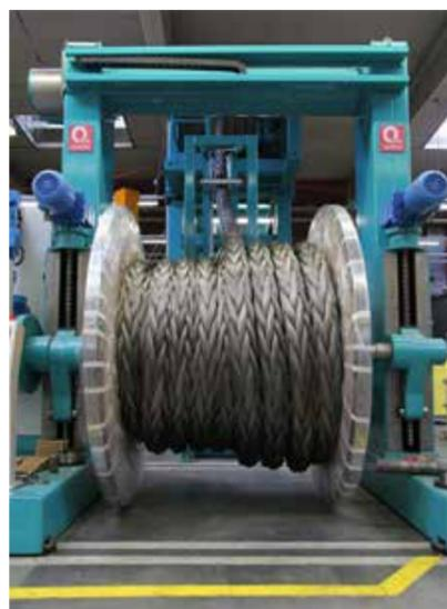
solides jamais fabriquées par Gleistein. En tout, 12 élingues ont été fabriquées à partir de cordes DynaOne® à 12 brins d'un diamètre de 128 mm. Chaque élingue dispose d'une résistance à la rupture de 4500 tonnes. Les élingues seront utilisées ensemble dans une seule construction de levage afin de créer une combinaison extrêmement solide et robuste pour une utilisation sur l'une des plus grandes grues au monde.
