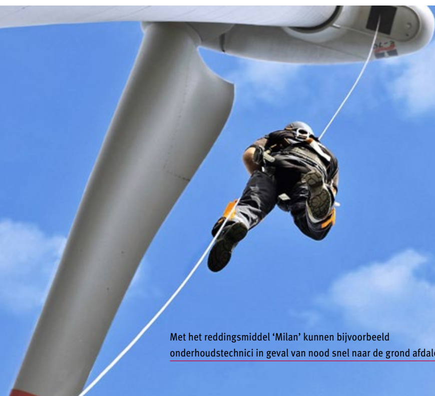
De ‘Milan 2.0 Hub’ kan als reddings- en afdaalmiddel worden gebruikt – en biedt de mogelijkheid om een persoon die een ongeluk heeft gehad een klein stukje op te heffen.
